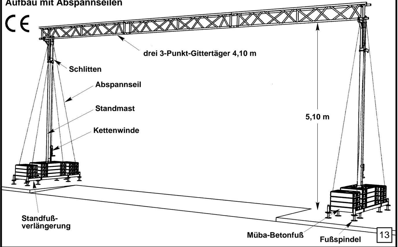
**Kabelbrücke Typ KB 11,5 mit Standfußverlängerung und Abspannseilen:**
